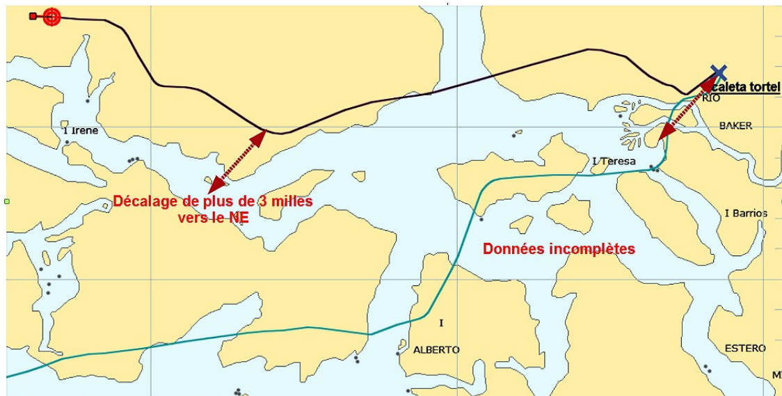
Exemple de décalage: trace enregistrée en Patagonie.
