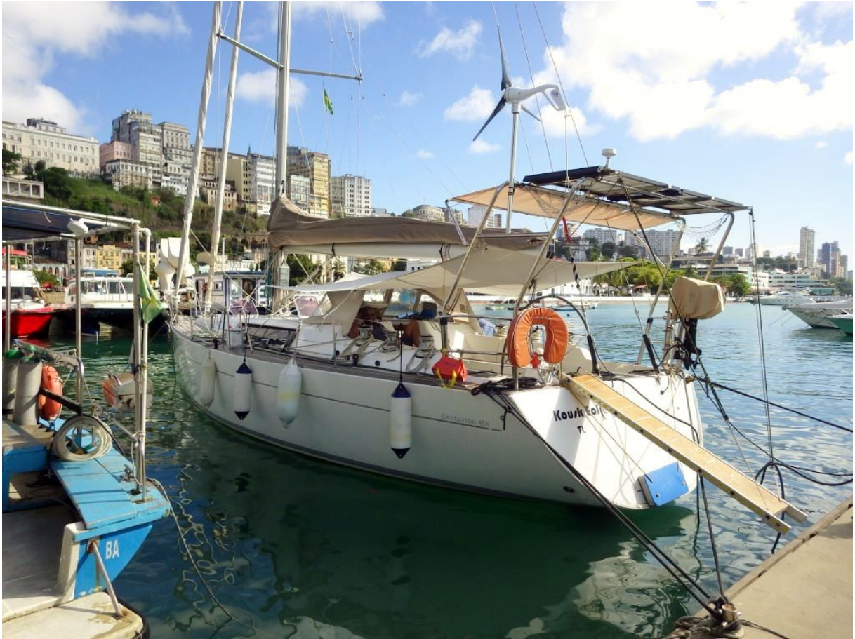
Le portique, avec l'éolienne et la protection du barreur.
